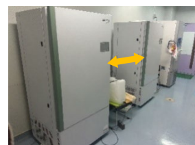
例: 人工気象器の側面放熱部のスペース確保
