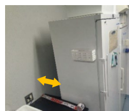
例: フリーザーの背面放熱部の隙間(300mm)
