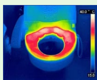
トイレの便座ヒーターをサーモグラフィカメラで撮影した画像（サーモグラフィHPより）
