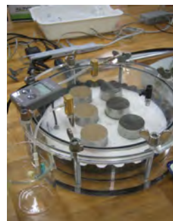
図2 保水性試験器例
