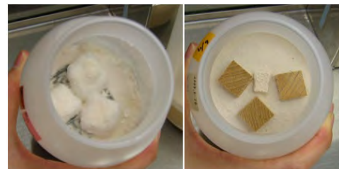
図 木材保存剤の防腐性能試験
