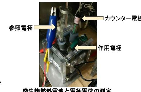
微生物燃料電池と電極電位の測定
