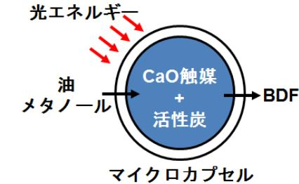
図1 光エネルギー駆動型BDF合成プロセスの概念図
