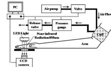
図1 近赤外光を用いた血管可視化装置概略
