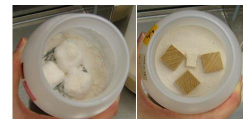
図 木材保存剤の防腐性能試験
