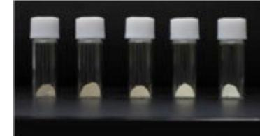
酸素欠陥制御した酸化物粒子
