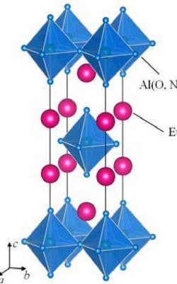
図1  $\text{Eu}_2\text{AlO}_{3.75}\text{N}_{0.1}$  の結晶構造
