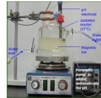
図1 *in vitro*人工消化試験機器
