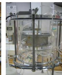
図3 透水性試験器例
