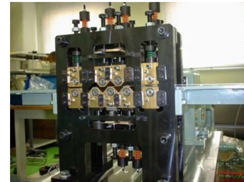
図1 連続繰り返し曲げ加工(CCB)装置
