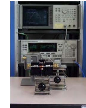
遮断円筒導波管法の測定システム例
