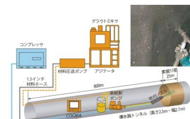
図 長距離圧送吹付け施工の例
