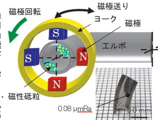
図1 加工原理とエルボ内面の加工
