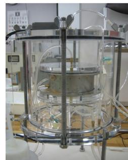
図3 透水性試験器例
