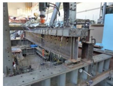
写真2 合成桁の載荷実験
