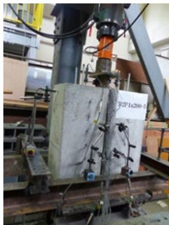
写真1 ずれ止めの要素試験一例
