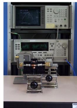
遮断円筒導波管法の測定システム例
