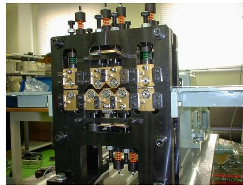
図1 連続繰り返し曲げ加工(CCB)装置
