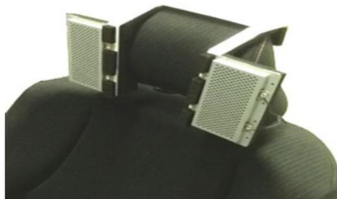
図1 耳側音響システムプロトタイプ
