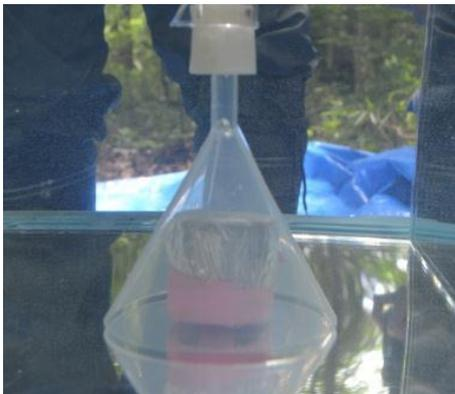
図4. 100 mlの採土円筒を用いた土壌空気の量を測定する実験
