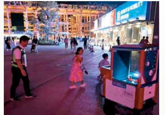
EXPO2025会場にて、空中ディスプレイを搭載する 広告ロボット (SignageBot) が参加者を認識し追尾している様子
