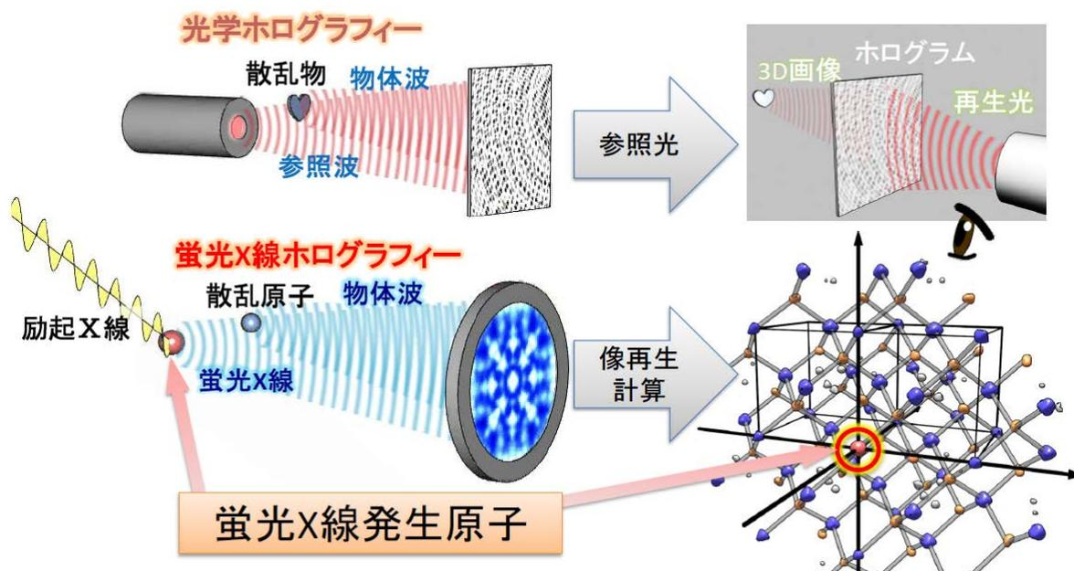
蛍光 X 線ホログラフィーも、基本的には光学ホログラフィーと同じ原理を用いています。蛍光 X 線とは、大きなエネルギーを原子に吸収させると放出される X 線のことで、それぞれの元素に固有の波長を持ちます。図に示してあるように、ある原子から放出された蛍光 X 線は近くの原子によって散乱され、それが物体波となります。物体波は蛍光 X 線発生原子からの参照波と干渉しホログラムを形成します。そのホログラムパターンは、X 線カメラで観測できます。蛍光 X 線ホログラフィーにおける像の再生では、光学ホログラフィーと同様にホログラムに参照波を照射しても再生像が小さすぎて人間の目で見ることはできないので、計算機を用いて行います。本手法は特に、単結晶中の微量不純物元素周りの局所原子配列を三次元で直接評価するのに有効であることが実証されています。
