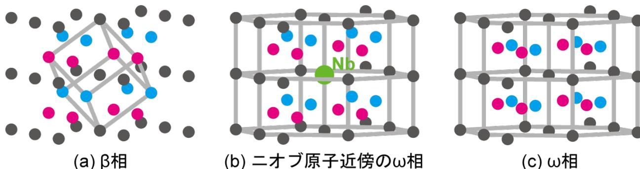
図5: (a) 一般的な $\beta$ 相, (b) ニオブ原子近傍の $\omega$ 相, (c) 一般的な $\omega$ 相の原子配列. (c)の原子配列をとるべき $\omega$ 相中にもかかわらず, ニオブ原子近傍では原子配列が $\beta$ 相に近いことが明らかになりました.
