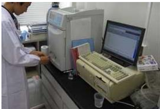
図5. イオンクロマトグラフによる測定の様子
