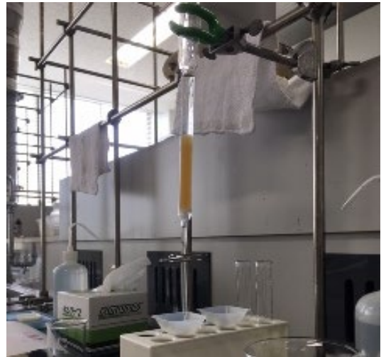
図4. イオン交換樹脂の充填されたカラム
