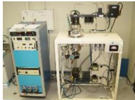
図1. ダイヤモンドの人工合成装置
