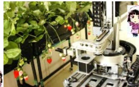
イチゴ収穫ロボットの収穫実験
