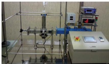
図1 マイクロ波加熱装置
