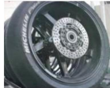
図2. アルミ合金上に鉄クロム合金めっきされたオートバイ用ブレーキディスク(企業との共同研究成果)
