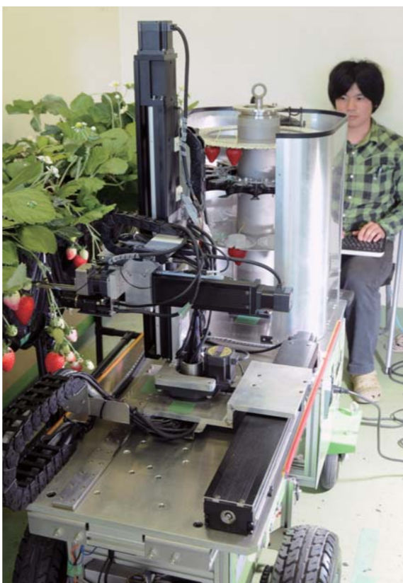
■「イチゴ収穫ロボット」：どこの農場にも持って行けるように自走式になっている。センサーで周辺を認識しイチゴの棚に沿って移動する。搭載したカメラで画像処理を行って色（熟度）、大きさ、位置を識別して茎の部分をつまんで摘み取る。イチゴを傷つけないように、置くのではなく、ぶら下げる状態でロボット本体にセットしてあるフレシエル®にホルドできるのが特長。（パソコンでロボットを操作しているのは本学機械知能工学専攻1年 熊沢秀樹）
