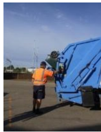
4種リサイクルゴミ同時収集できる収集車
