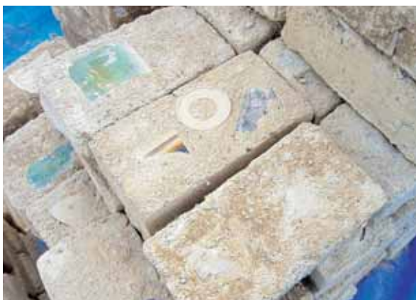
図3 日干しレンガには、東日本大震災で破損した益子焼の陶片が埋め込まれている
