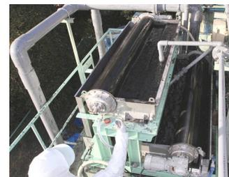
図3. 200m<sup>3</sup>/日を目指す実用磁気分離装置の開発
