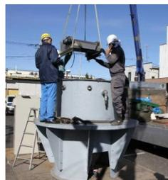
図2. 可搬型パイロットプラントによる食品排水処理試験
