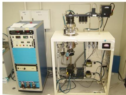
図2. ダイヤモンドの人工合成装置
