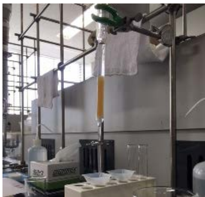
図3. イオン交換樹脂の充填されたカラム
