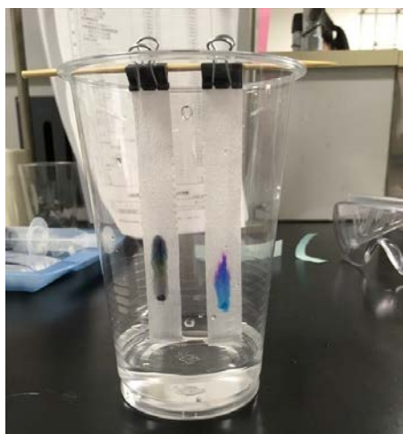
図6. ペーパークロマトグラフィーでペンのインクの色素を分離する様子
