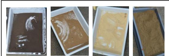
写真 3. 泥団子作りに用いた土壌試料(左から、森林下の A 層, B 層, 鹿沼軽石 B 層, 荒木田土)
