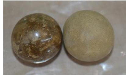
写真 5. 研磨前後の泥団子(左:研磨後)。使用した土は、荒木田土。
