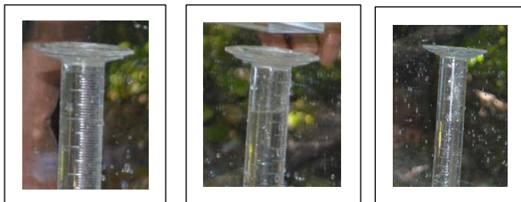
図5. 右から、A層、B層、鹿沼軽石B層 (A層の円筒管から放出された空気が最も多く、鹿沼軽石B層から放出された空気が最も少ない。)
