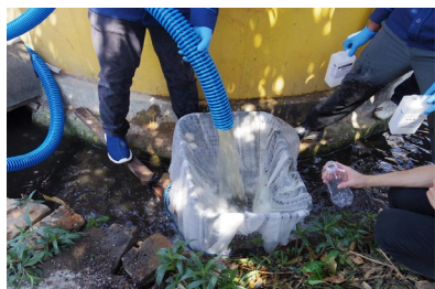
水道管内の水質調査
