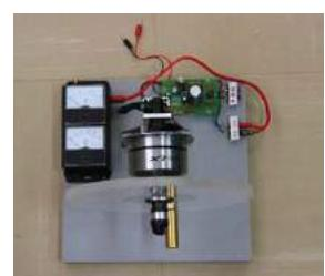
図2 自作の手回し発電機
