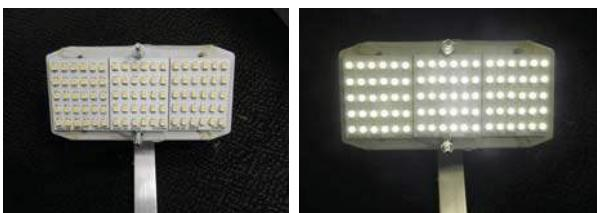
図8 手回し発電でLED照明
