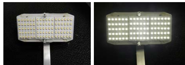
図8 手回し発電でLED照明
