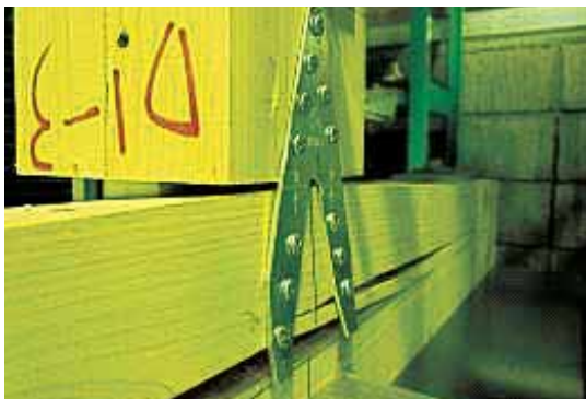
図4 試験時の破壊状況
